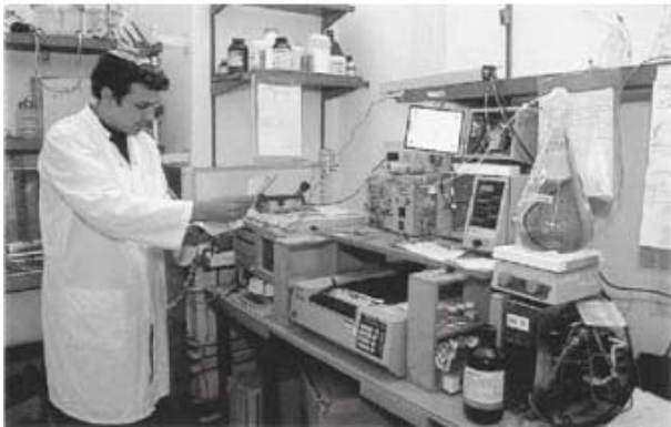
ד"ר גל ידיד במעבדתו, ליד מכשיר High Performance Liquid Chromatography (HPLC) המשמש לזיהוי וכימות דופמין ומטבוליטים שלו בדגימות של נוזל
